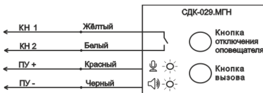
Рис. 3. Подключение СДК-029.МГН
